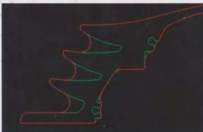
輪郭加工 NC径補正(工具径干渉付)
